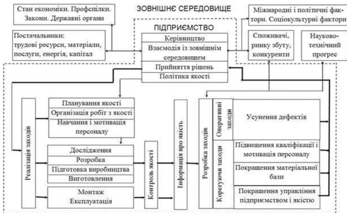
Рис. 2.4. Функціональна схема управління якістю продукції (петля якості)
